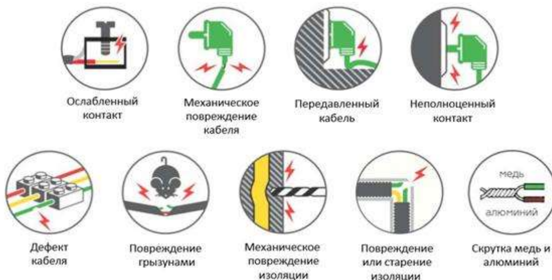
Рисунок 6. Возможные причины искрения в электропроводке
